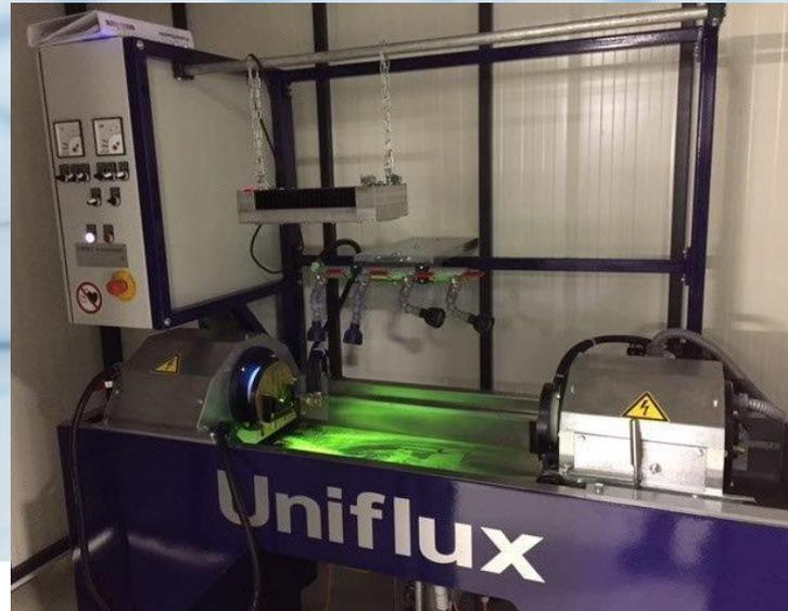
Universell einsetzbar durch flexible Auslegung von Strom- und Felddurchflutungsstärke-
