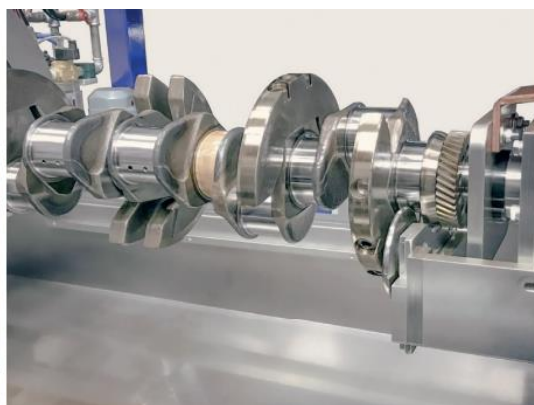
Prüfling bei der Stromdurchflutung
